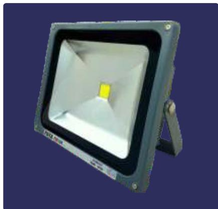
این مدل در حالت عادی با برق شهر با توان ۵۰ وات نوردهی می‌کند. هنگام قطع برق بطور اتوماتیک و آنی با باتری با توان ۱۴ وات نوردهی می‌کند. در ابتدای با توان ۲۰ وات و پس از ۳ دقیقه کاهش تدریجی با توان ۱۴ وات به مدت ۲ ساعت نور دهی می‌کند. این مقدار نور برای تامین روشناهی اضطراری محظوظه ای به وسعت ۱۲۰ متر مربع کفایت می‌کند.
